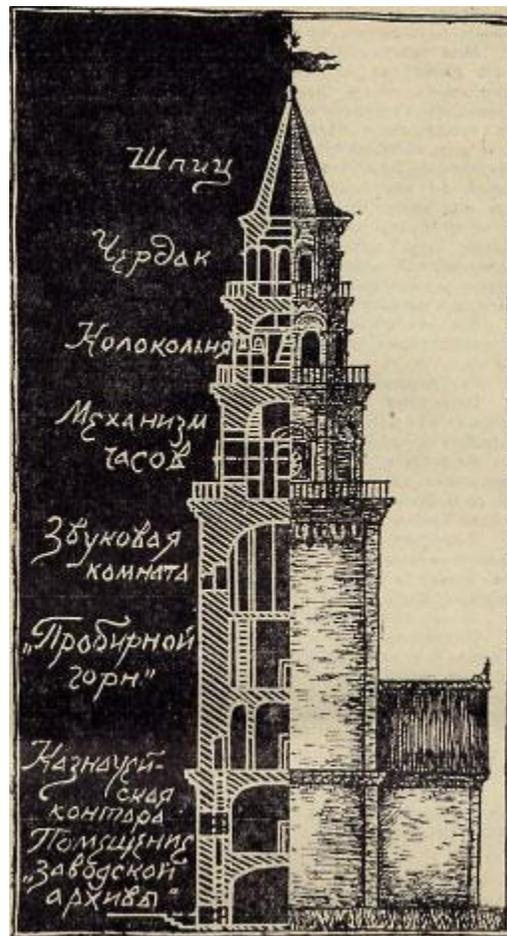
Рис. 5. Наклонная башня Демидовых в разрезе
